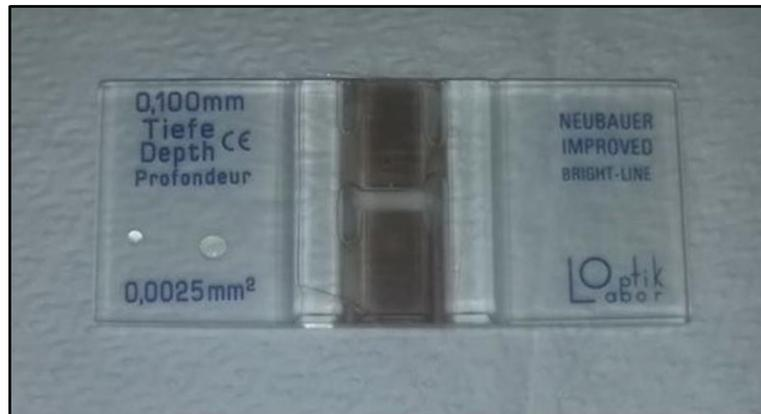
**Figura 3:** Câmara de Neubauer com solução aquosa
