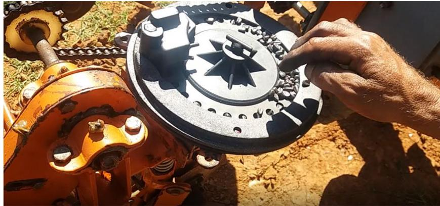
**Figura 12 – Escolha do disco de distribuição de sementes para regulagem da Máquina plantadeira no Rancho JB - Nova Era/MG**
