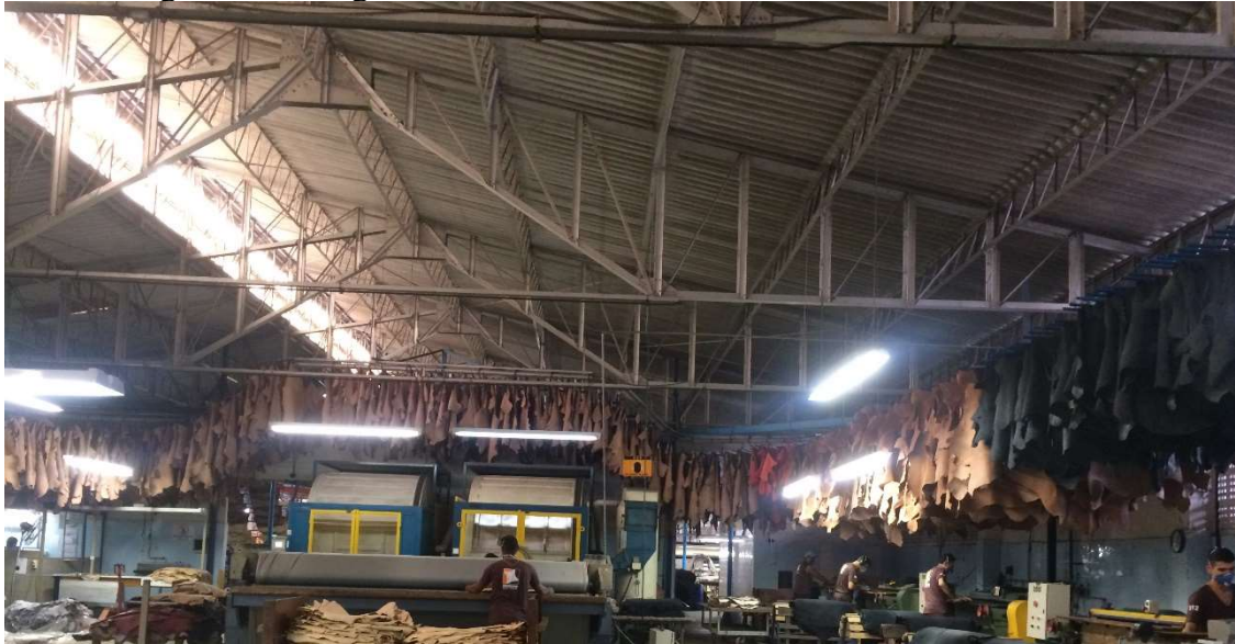
Figura 18: Secagem natural do couro no ambiente interno do curtume
