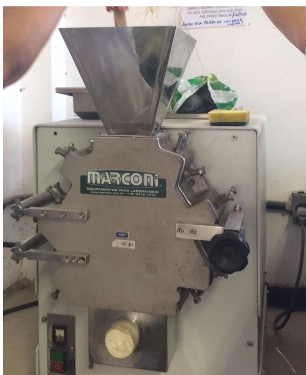
Figura 11 - Moagem das forrageiras no moinho tipo Wiley.
