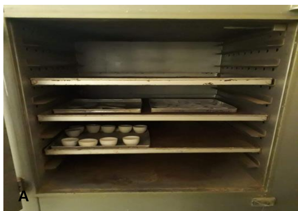
Figura 24 - Determinação de MS (a) e determinação de MM em forno mufla (b).
