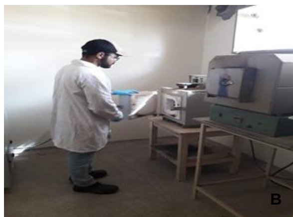
Figura 24 - Determinação de MS (a) e determinação de MM em forno mufla (b).
