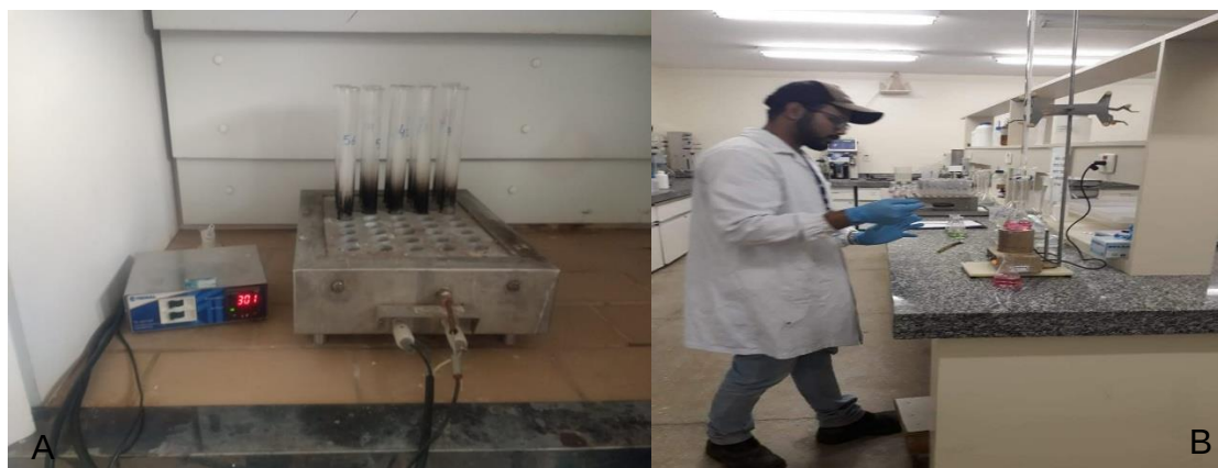
Figuras 27 - Tubos em bloco digestor (a) e titulação das amostras (b).
