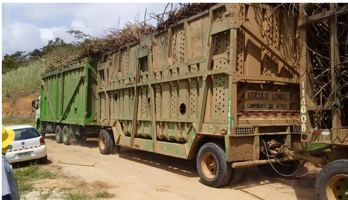
Figura 27 - Caminhão canavieiro com reboques atrelados, realizando o transporte dos colmos.
