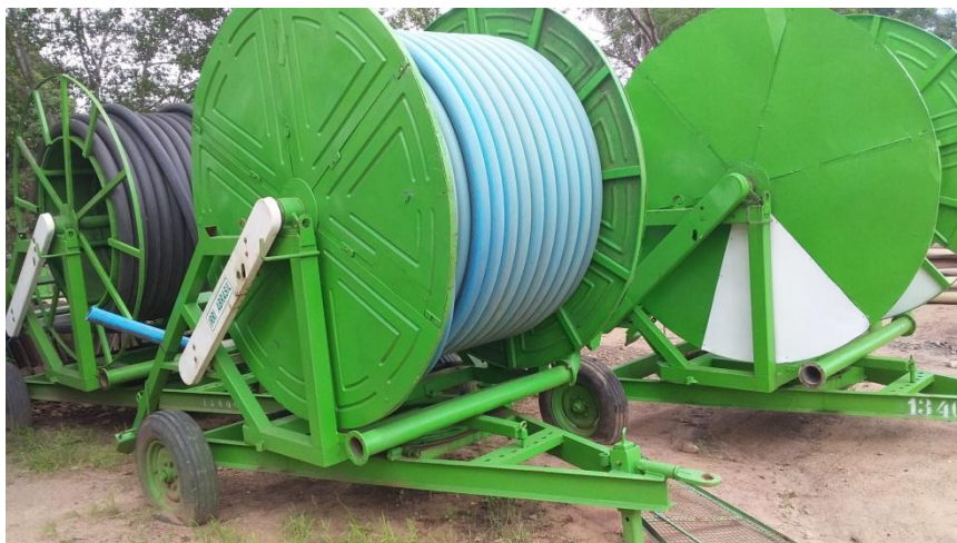
Figura 10 - Sistema de irrigação autopropelido.
