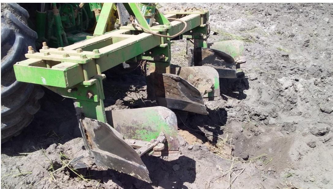
Figura 6 - Modelo de sulcador utilizado pela empresa.
