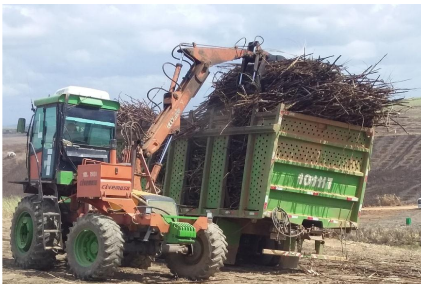
Figura 26 - Enchimento do caminhão com utilização de uma carregadeira.
