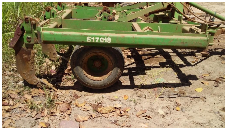
Figura 3 - Modelo de subsolador utilizado pela empresa.
