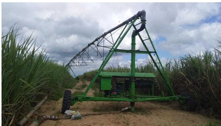
Figura 9 - Sistema de irrigação por pivô central.
