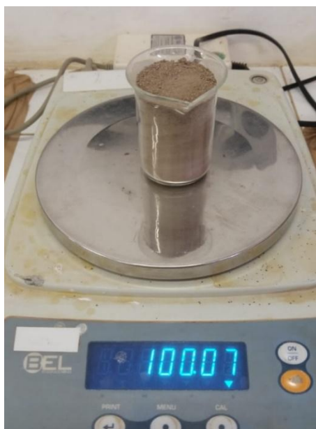
Figura 5: Pesagem das amostras de solo em Becker de 50ml (Fonte: Cássio Lopes)
