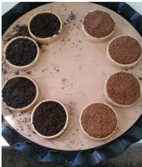
Figura 4: Amostras de solo sobre placa porosa (Fonte: Cássio Lopes)
