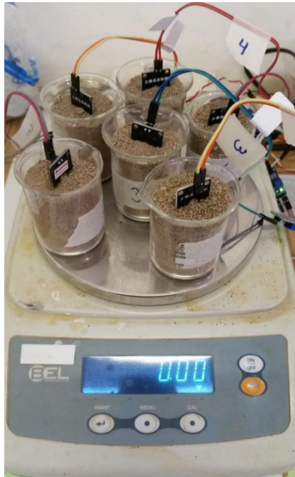
Figura 8: Sensores HL-69 inseridos nas amostras de solo (Fonte: Cássio Lopes)
