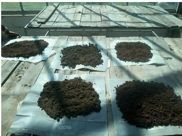
Para cada corpo de amostra, foram separadas duas porções de 50g para decantação com dispersante em duplicata e uma de 20g, para determinação do fator F. O dispersante empregado foi  $\text{CaCO}_3$ . As porções para decantação foram transferidas a garrafas e diluídas em solução de água e 25mL de dispersante, completando 250g em todas as garrafas.
