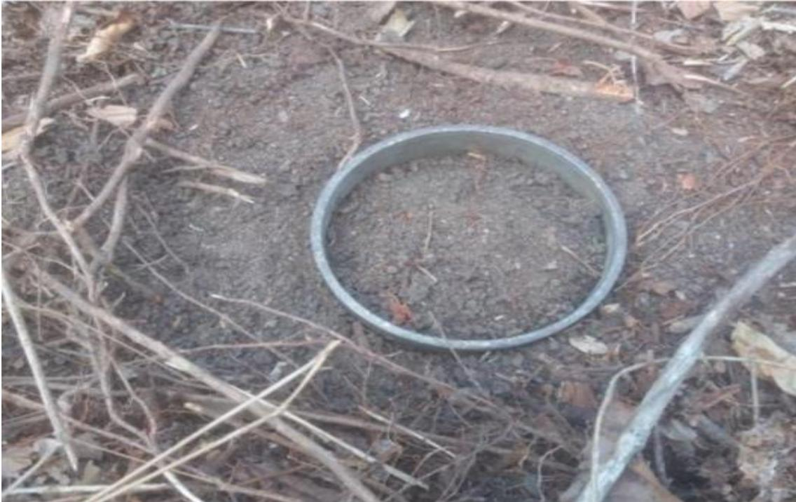
Figura 4: Teste de infiltração realizado com anel simples de 15 cm na camada de 0-10 cm, na área de mata nativa.
