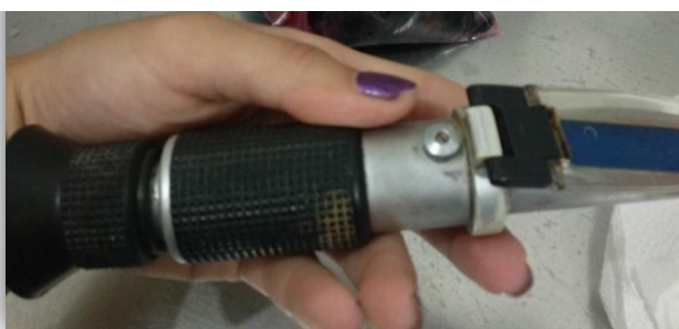
Figura 22- Refratômetro para medição do teor de sólidos solúveis (CAJ-BA, 2018).
