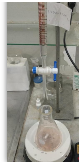
Figura 24- Análise da acidez por titulação volumétrica com agitador magnético.
