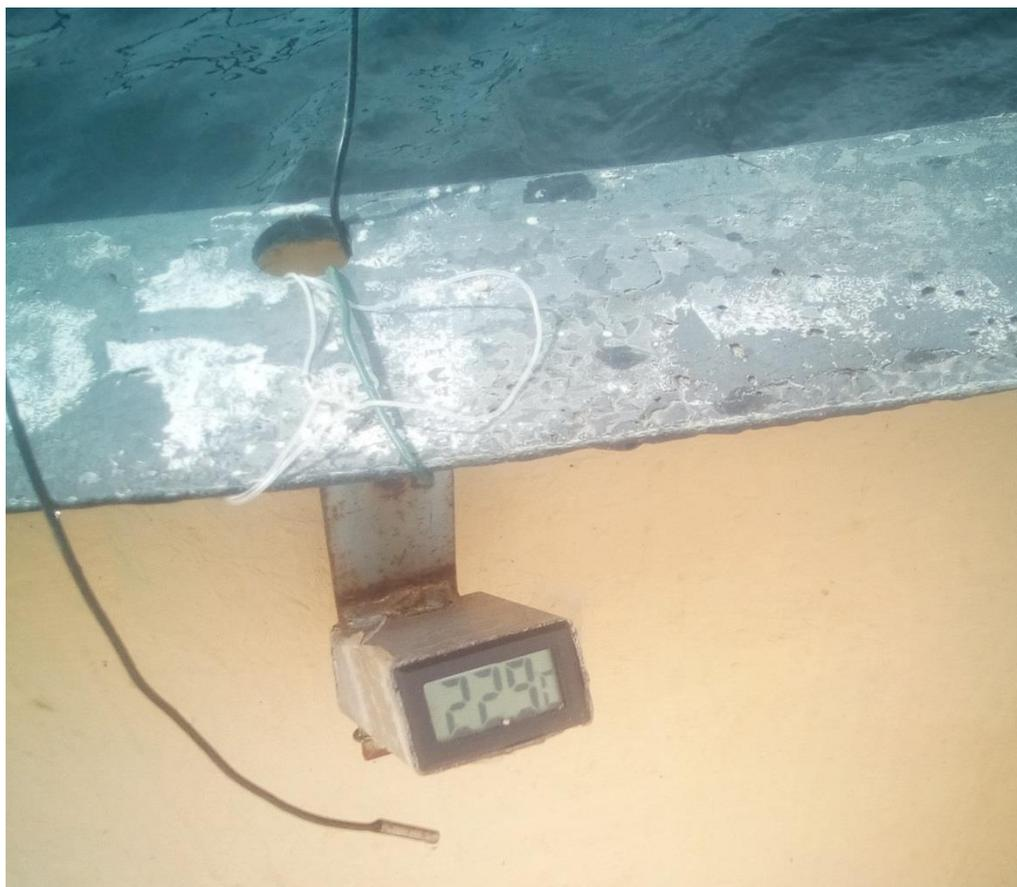
**Figura 8.** Termômetro usado para o monitoramento da temperatura no setor alevino 1.
