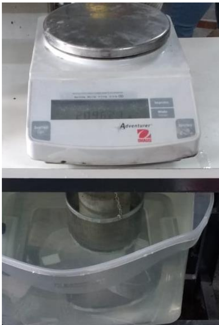
Figura 13 - Balança hidrostática em funcionamento. Fonte: Autor, 2018.
