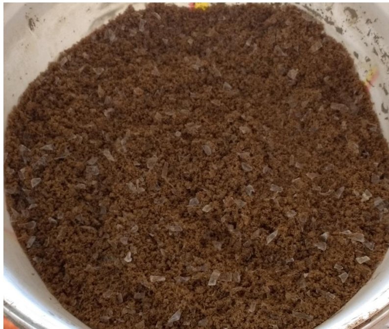
Figura 12 - Flakes de PET homogeneizados na areia.
