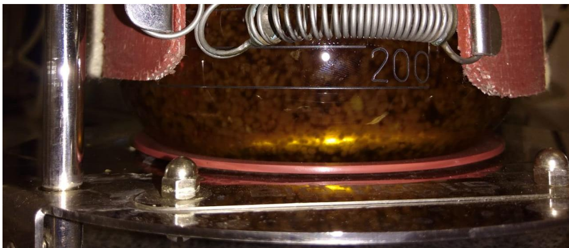
Figura 12. Biomassa fúngica formada no término da fermentação (137h) fermentação submersa em batelada do Aspergillus aculeatus URM 4953 realizada em biorreator.
