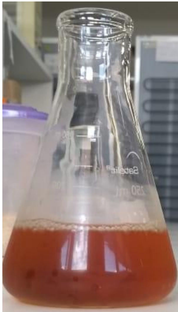
Figura 7: Meio fermentativo elaborado a partir do resíduo de casca maracujá e utilizado para a obtenção de PG do Aspergillus aculeatus URM 4953 por fermentação submersa (FS) em batelada em biorreator.
