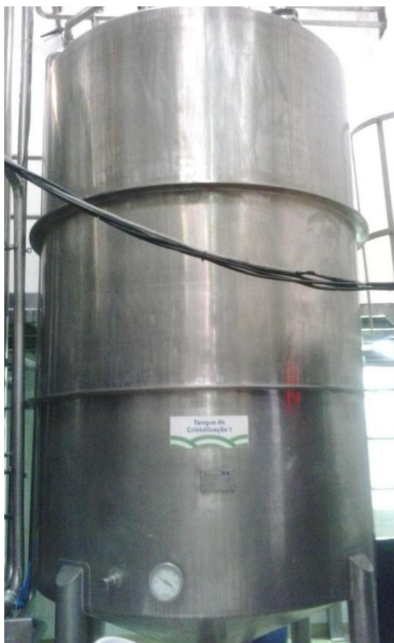
Figura 16: Tanque de Cristalização com volume de 5.000L.
