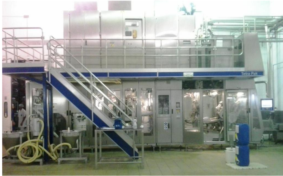
Figura 08: Máquina de envase asséptico.
