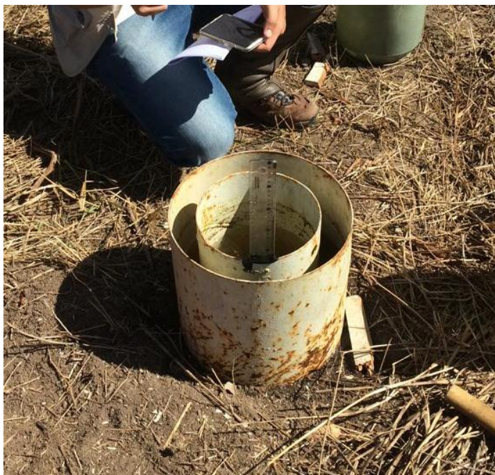
Figura 5 - Determinação da velocidade de infiltração básica (VIB) no solo, ensaio importante para determinar a taxa de infiltração no mesmo com ajuda da tabela de infiltração e com o infiltrômetro de anéis concêntricos, proporcionando infiltração vertical da água.
