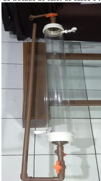
Figura 19 – Casco do trocador de calor de casco e tubo com conexões.
