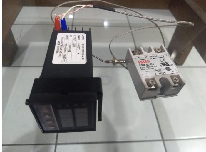
Figura 17 – Controlador PID (esquerda) e Relé de estado sólido.
