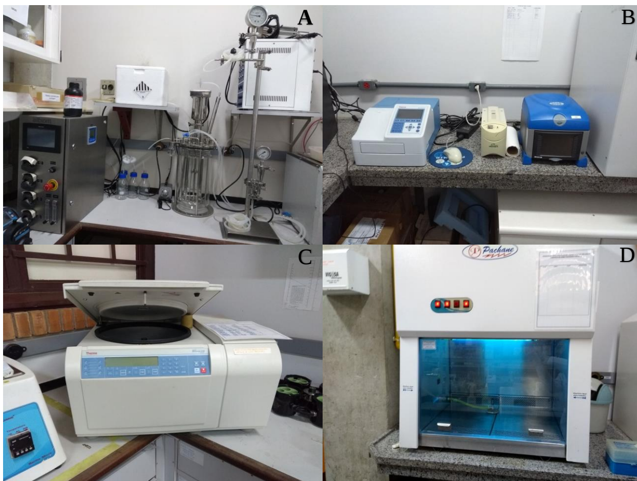
Figura 3. Equipamentos que fazem parte do Laboratório de Biologia e Controle de Hematozoários e Vetores do BIOAGRO. A. Biorreator utilizado nas etapas de produção de vacinas contra carrapatos; B. Leitor de ELISA (esquerda) e Termociclador para PCR (Direita); C. Centrífuga utilizada para separação de material em recipientes de diferentes tamanhos; D. Capela de fluxo laminar (Arquivo pessoal).
