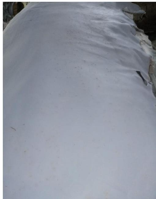
**Figura 20:** Couro wet-blue classificado como RR devido aos danos causados pelo carrapato.
