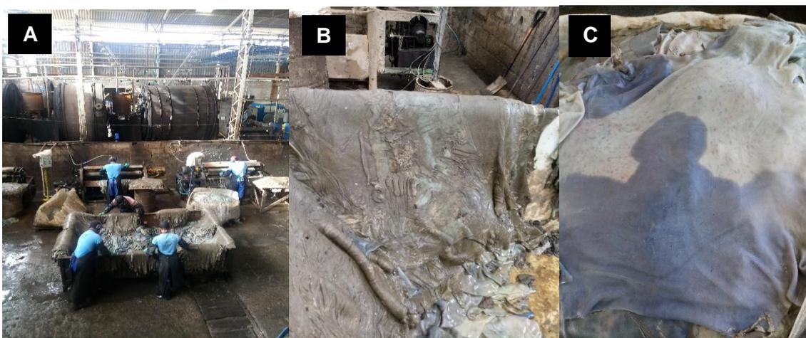
**Figura 10:** A – setor de descarne. B – Pele antes do descarne. C – Peles após o descarne.
