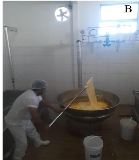
**Figura 50:** Processos na fabricação do queijo de manteiga.
