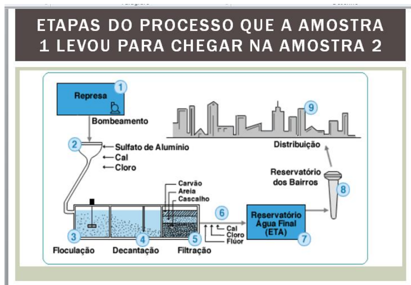
Figura 5: ilustração de uma Estação de Tratamento de Água
