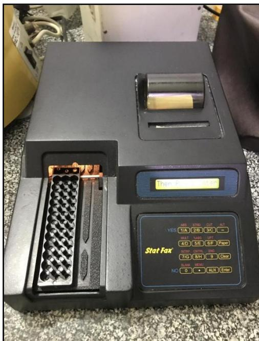
**Figura 6.** Espectrofotômetro da Stat Fax para leitura de densidade óptica.
