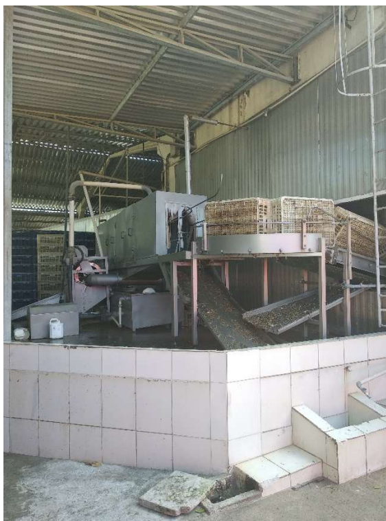
Figura 26: Máquina de higienização de caixas de transporte de aves
