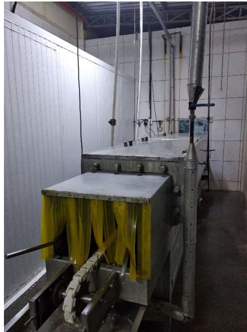
Figura 27: Máquina de higienização de caixas de produto
