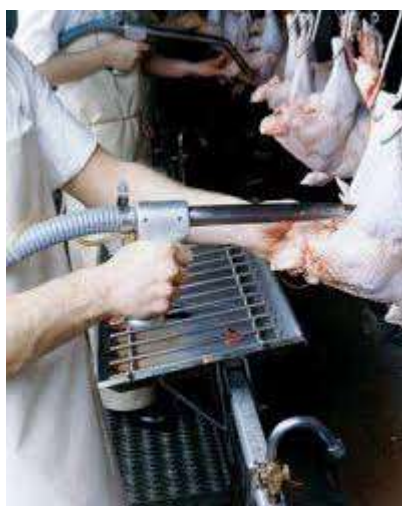
Figura 24: Pistola extratora de pulmão
