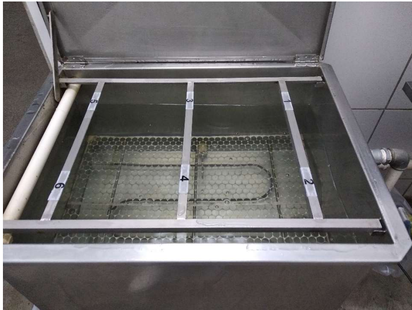
Figura 25: Banho maria para dripping test
