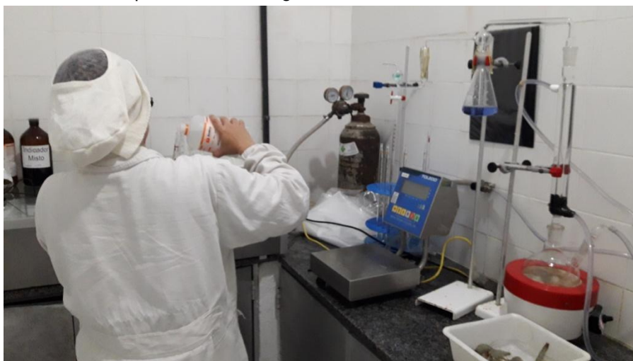
Figura 15 – Equipamento para a realização do Monier Willamis, laboratório do controle de qualidade, Romanguera Pescados e Frutos do Mar, 2018.
