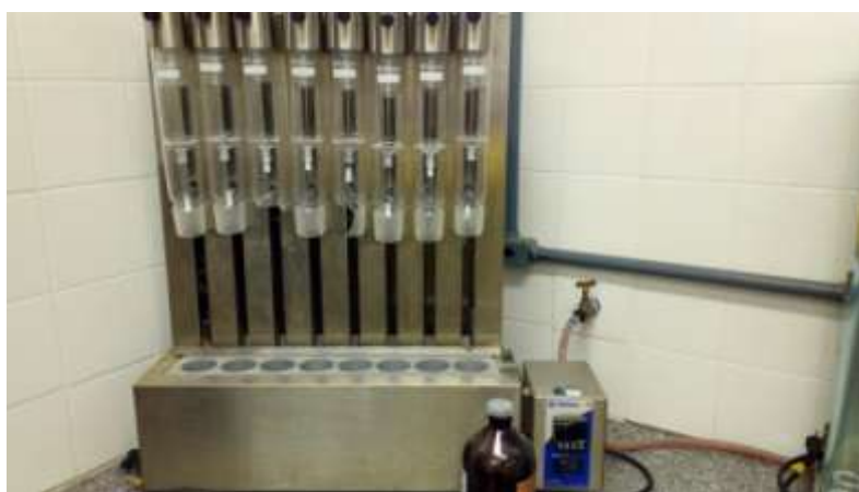
Figura 8. Extrator de gordura tipo Goldfisch. Fonte: Arquivo pessoal
