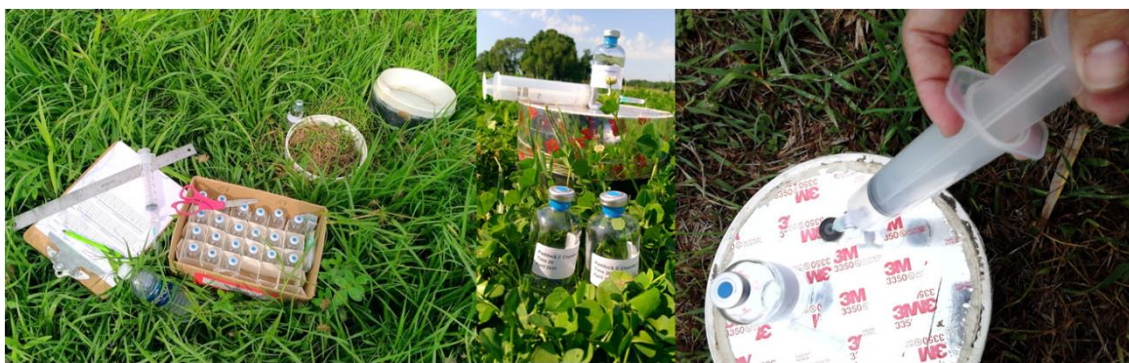
Figura 3. Vista da câmara aberta, após as mensurações de altura, seguido do fechamento para o início das coletas de gás.
