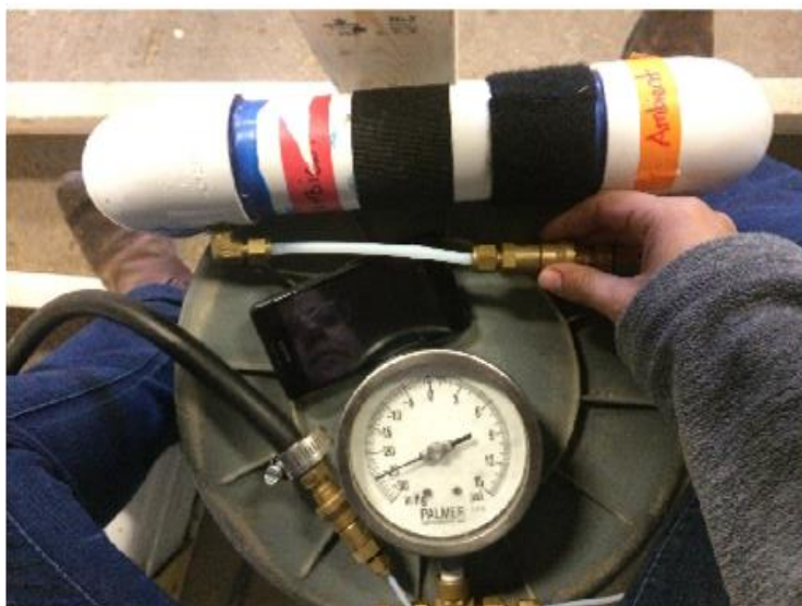
Figura 6. Preparação do equipamento de armazenamento do gás com vácuo a -25psi.
