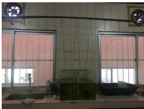
Figura 20. Pontos de aeração instalados. Fonte: Acervo pessoal, 2019.
