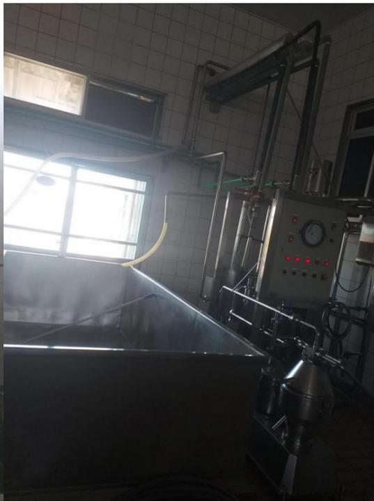
**Figura 26-** Equipamentos da linha de produção 2. A) Desnatadeira, B) Tachos, C) Embaladora a vácuo e esteira, D) Produção queijo de manteiga.
