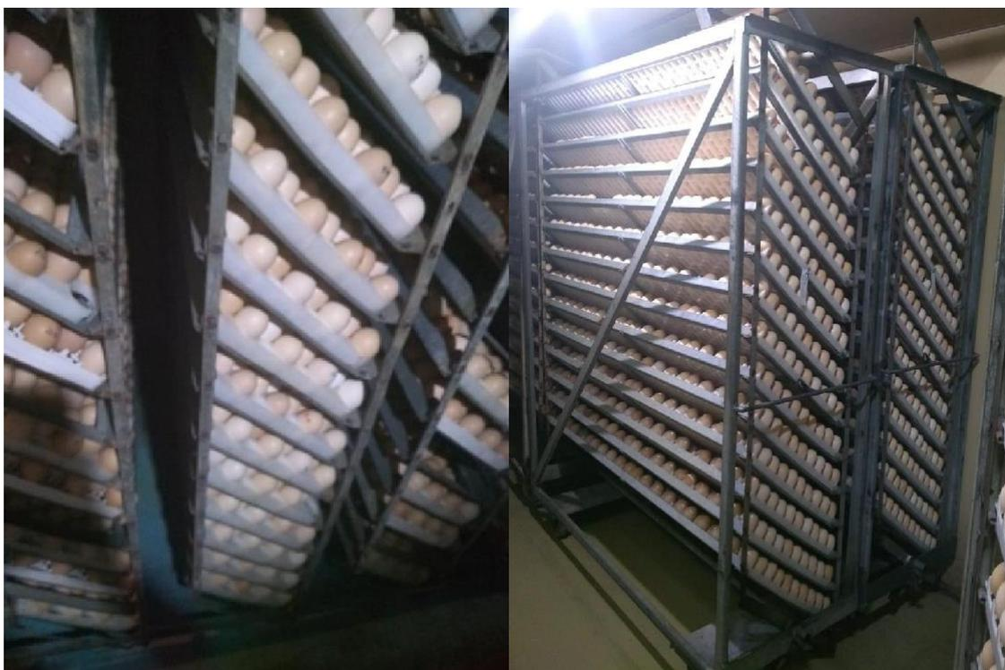
Figura 2. Esquema de viragem dos ovos na Incubadora de Estágio Múltiplo Fonte: Arquivo pessoal
