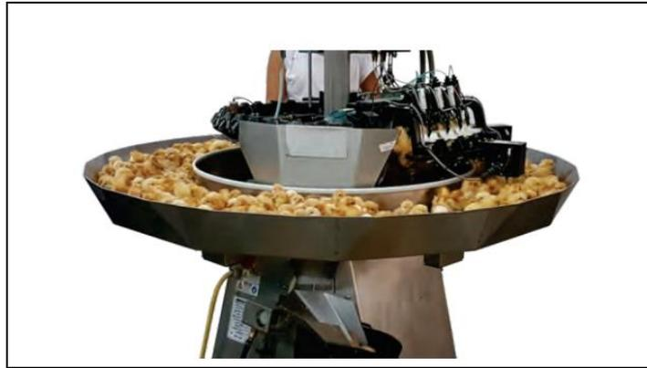
**Figura 33** - Modelo da máquina de debicagem e de vacinação subcutânea.
