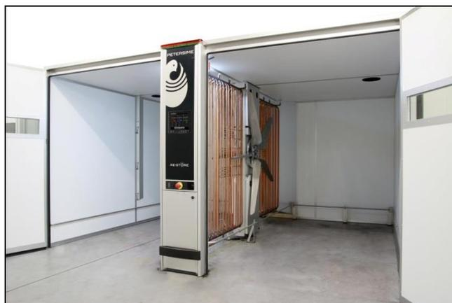
**Figura 21-** Modelo da máquina para o tratamento térmico de ovos armazenados.
