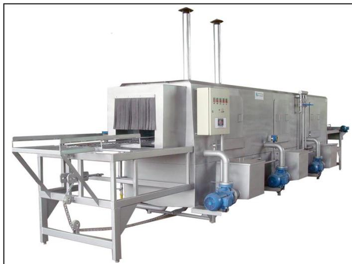
**Figura 30** – Modelo de lavador de caixas de eclosão.
