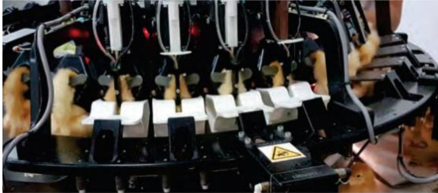
**Figura 35-** Modelo da estação de vacinação da máquina utilizada.
