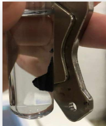
Figura 7: Resposta magnética do NGM (a) em pó seco finamente dividido e (b) no meio aquoso quando exposto a um campo magnético externo.
