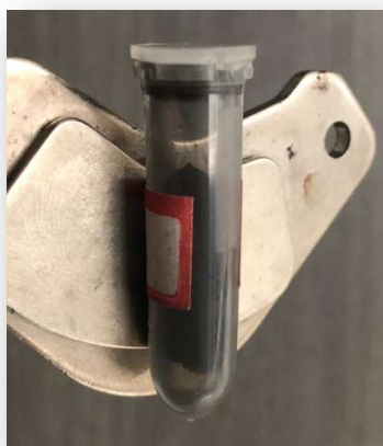
Figura 7: Resposta magnética do NGM (a) em pó seco finamente dividido e (b) no meio aquoso quando exposto a um campo magnético externo.
