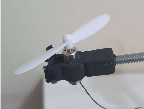
Figura 35. Motor utilizado no sistema Seesaw Propeller para reproduzir o sinal de saída do controlador sobre o sistema.
