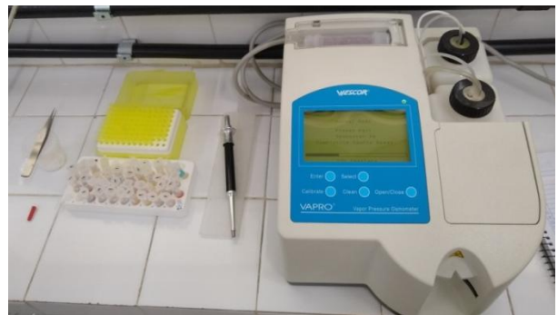
Figura 13 - Osmômetro VAPRO 5600 (Wescor®)
