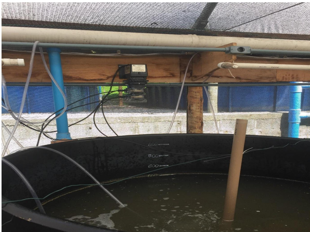
Figura 7: Tanque de rotíferos e bomba peristáltica (stenner pump)
