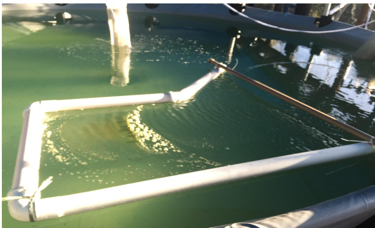
Figura 5: Skimer para remoção da gordura e proteína superficial.
