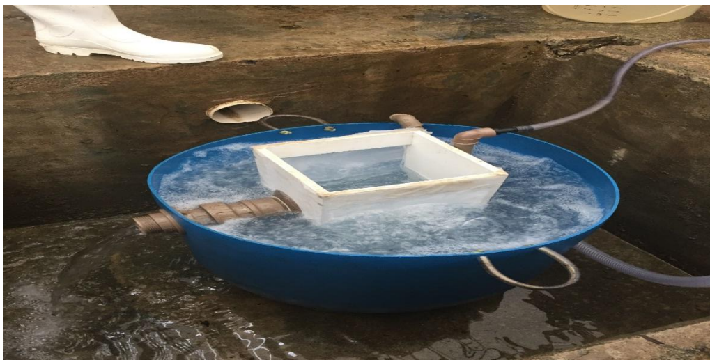
Figura 9: Balde filtro de 80 litros com malha de 65 micras
