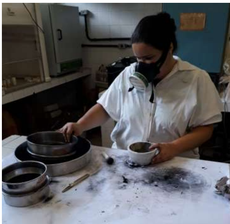
Figura 6 – Preparo das amostra para determinação do teor de cinzas
