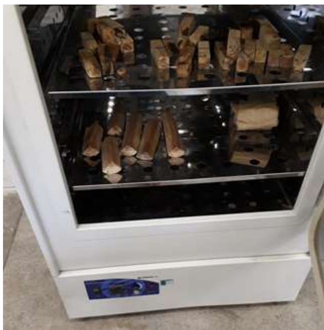
Figura 4 – amostras de madeira colocadas na estufa para secagem.
