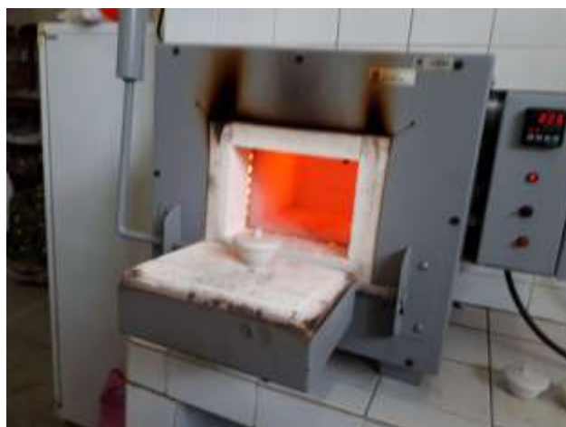
Figura 5 – Mufla utilizada para determinação dos materiais voláteis.
