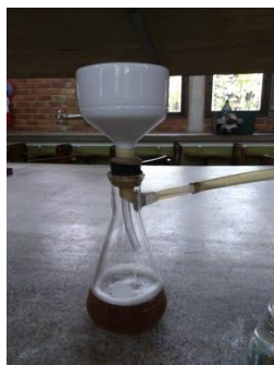
Figura 27 - Filtração a vácuo da amostra desengordurada com hidróxido de sódio (NaOH) 1,25%.
