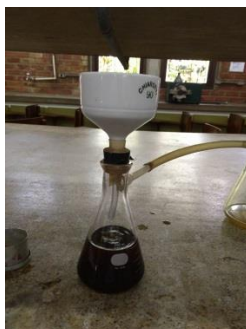
Figura 25 - Filtração a vácuo da amostra desengordurada com ácido sulfúrico ( \text{H}_2\text{SO}_4 ) 1,25%.
