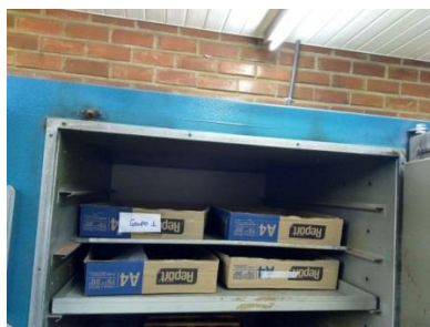
Figura 2 - Estufa de circulação forçada regulada a 60-70°C.
