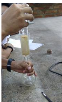
Figura 21 - Extrator de Soxhlet conectado ao balão coletor de boca esmerilhada.
