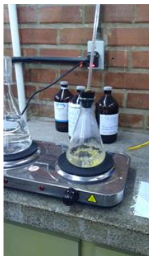
Figura 26 - Ebulição suave da amostra desengordura sob refluxo com hidróxido de sódio (NaOH) 1,25%.
