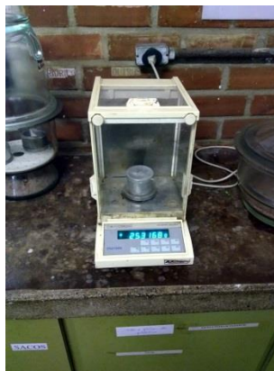
Figura 5 - Tara do pesa-filtro seco em estufa regulada a 105°C por 1h.
