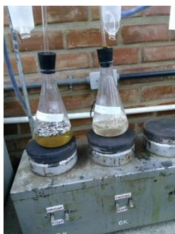
Figura 24 - Ebulição suave da amostra desengordura sob refluxo com ácido sulfúrico ( \text{H}_2\text{SO}_4 ) 1,25%.
