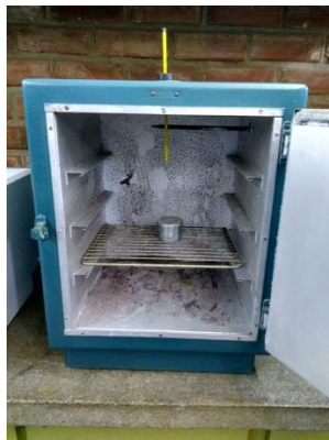
Figura 6 - Material desidratando em estufa regulada a 135°C por 1h
