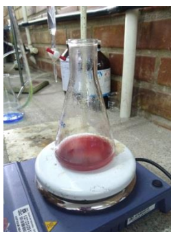
Figura 19 - Final da titulação com a mudança da cor da solução para vermelho tijolo.
