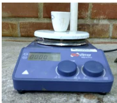
Figura 8 - Carbonização da amostra preparada.
