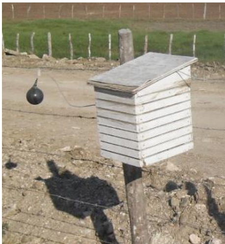
Figura 2. Abrigo meteorológico utilizado para o registro das variáveis meteorológicas externas.
