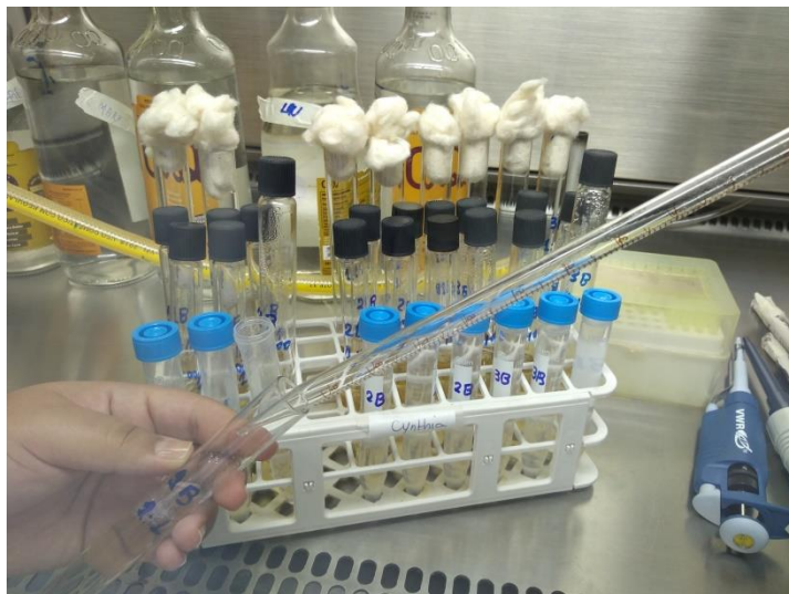
Figura 4. Inoculação das amostras em meio de cultura para pesquisa de coliformes após tratamento com hipoclorito de sódio.
