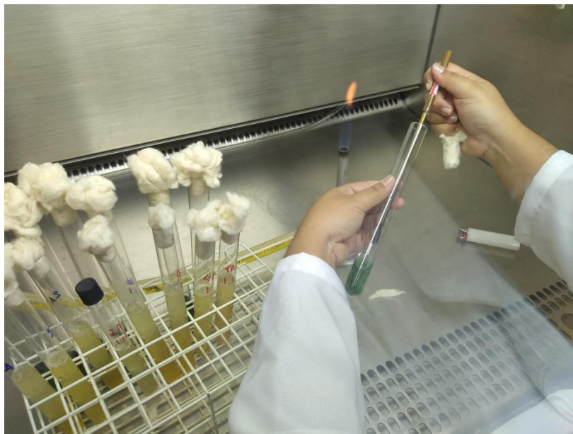
Figura 7. Transferência de uma alçada de amostra positiva de Caldo Lauril Lactosado para Caldo Verde Brilhante para realização da pesquisa de coliformes em amostra de água.
