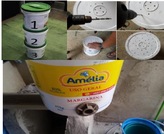
Figura 1. Montagem do sistema de compostagem
