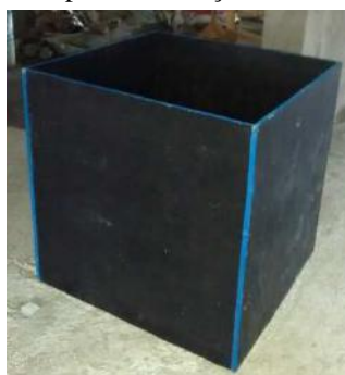
Figura 3. Caixote para verificação de volume dos traços
