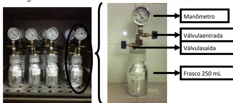
Figura 2. Detalhamento dos frascos utilizados no ensaio BMP.
