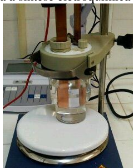
Figura 5. Sistema preparado para a síntese eletroquímica da MOF de [\text{Cu}_3(\text{BTC})_2(\text{H}_2\text{O})_3]_n
