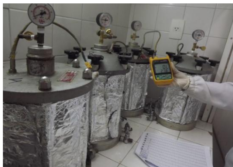
Figura 1. Reatores de bancada utilizados como fonte do resíduo envelhecido utilizado neste estudo.
