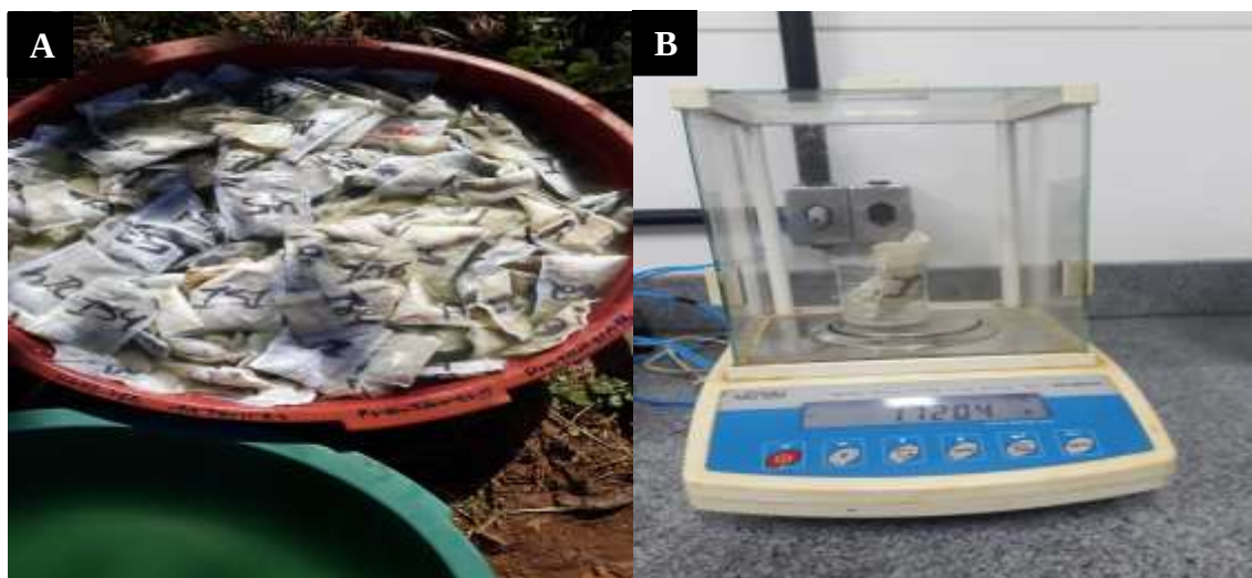
Figura 8. Sacos retirados após a incubação (A) e pesagem dos sacos para determinação do desaparecimento da matéria seca (B).
