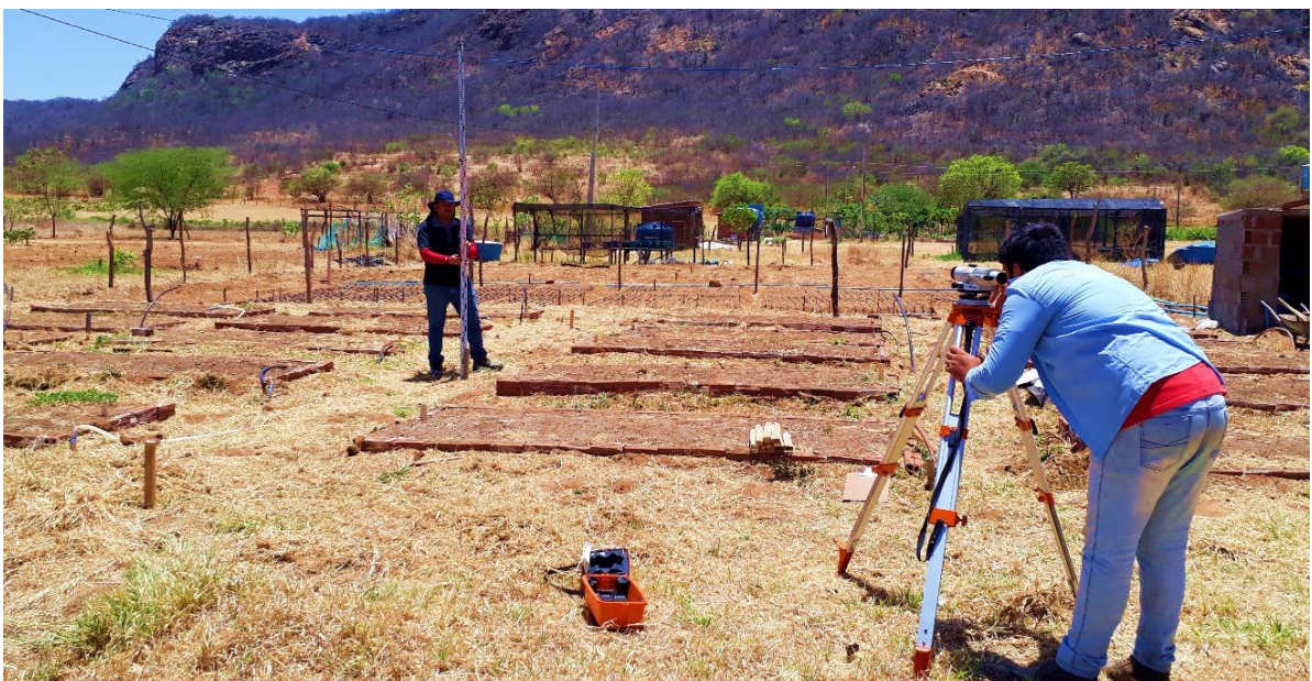
Figura 20. Coleta de dados com nível de luneta.
