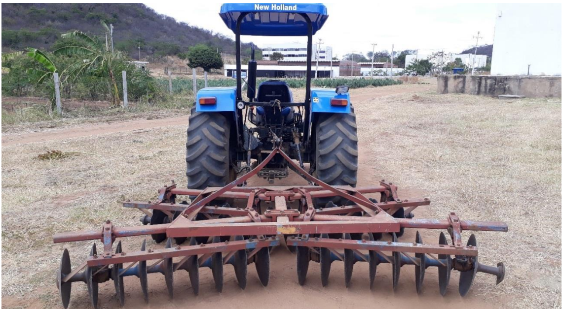
Figura 7. Grade niveladora 36 discos em X, utilizada para as atividades de preparo do solo.
