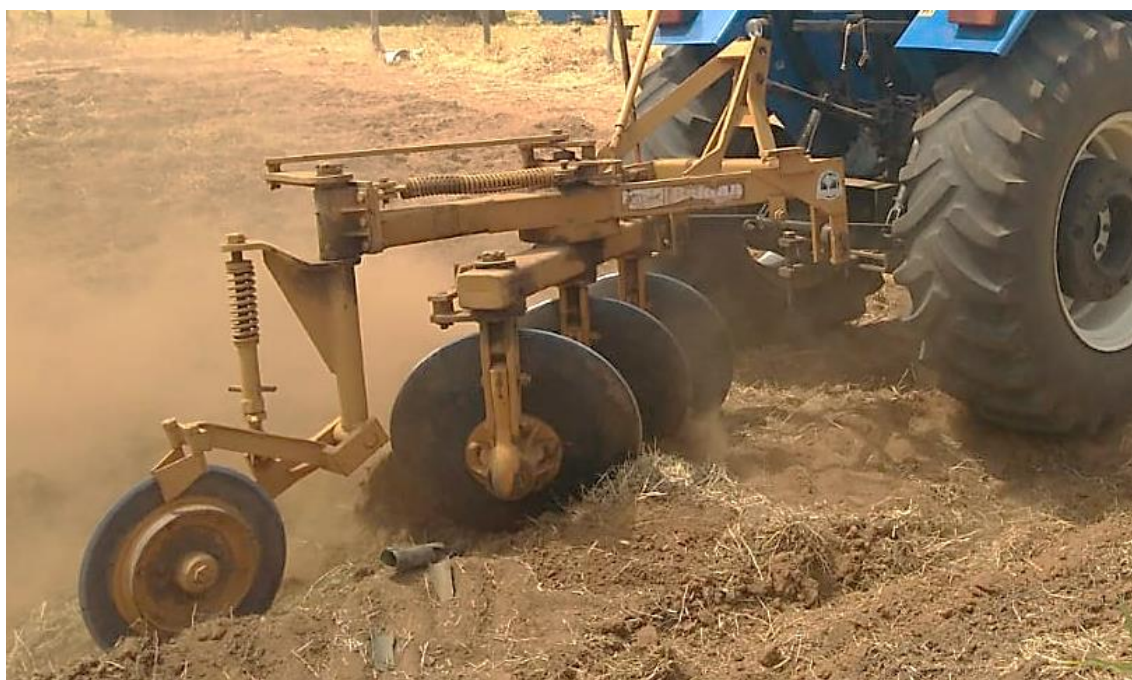
Figura 5. Arado reversível de 3 discos utilizado para as atividades de preparo do solo.
