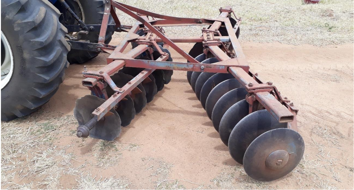
Figura 6. Grade niveladora 36 discos em X, utilizada para as atividades de preparo do solo.
