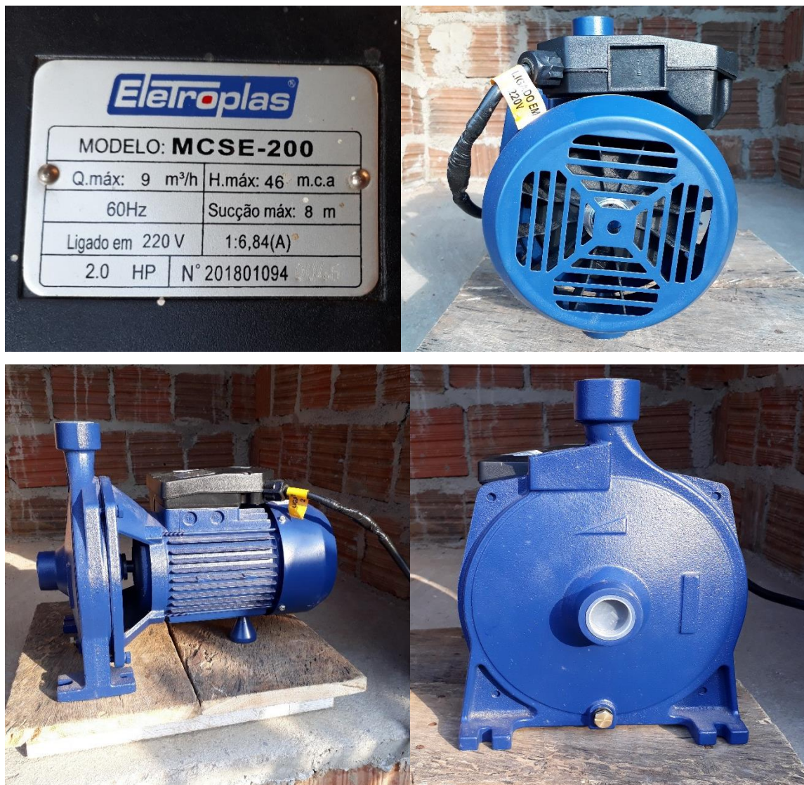
Figura 25. Conjunto Motor bomba.
