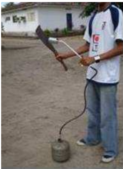
Figura 5. Adaptações de flambadores para desinfestação de instrumentos de corte através do método físico (calor).
