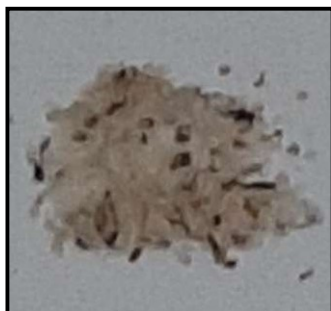
Figura 18- resíduo de peneiramento na malha 60 para a barbotina teste.
