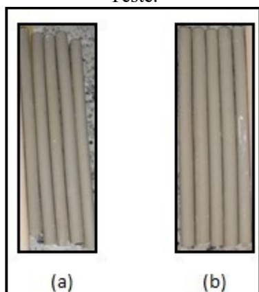
Figura 21- Corpos de provas sinterizados proveniente da barbotina (a) Padrão e (b) Teste.
