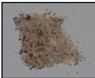
Figura 17 - resíduo de peneiramento na malha 60 para a barbotina padrão.
