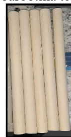
Figura 20- Corpos de prova desenvolvidos com a barbotina teste.
