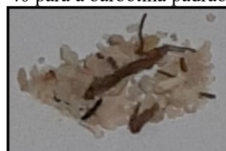
Figura 15 - resíduo de peneiramento na malha 40 para a barbotina padrão.
