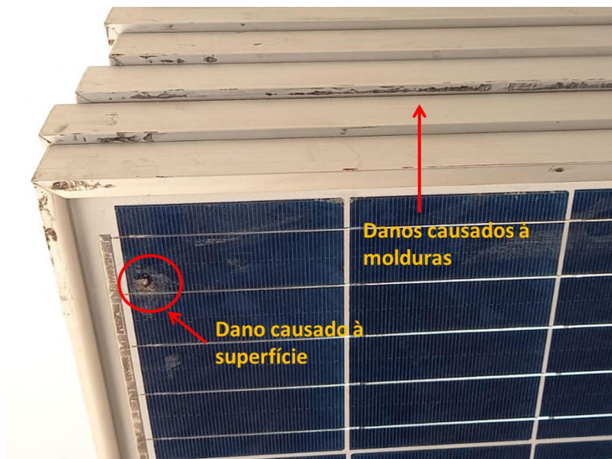
Figura 19 - Módulos avariados durante o transporte.
