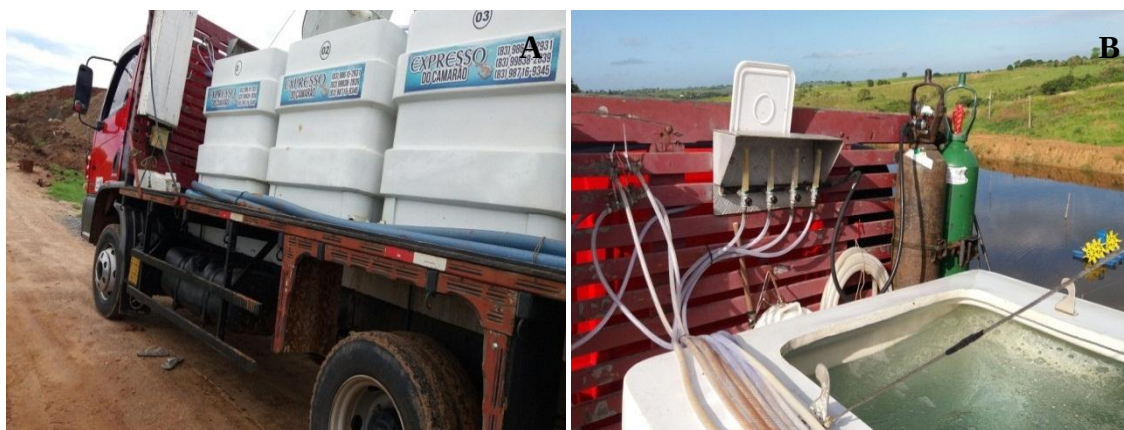
Figura 6. Máquinas e equipamentos utilizados no transporte de pós-larvas de camarão. A – Caminhão com caixas de transporte de organismos aquáticos; B – Detalhes do cilindro com oxigênio para aeração das caixas de transporte
