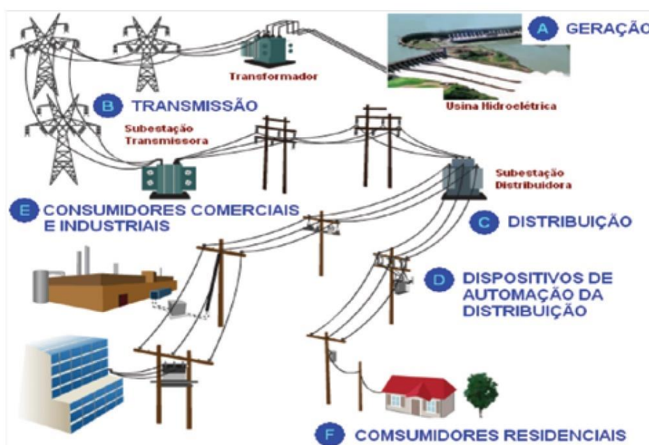
Figura 1: Sistema Elétrico de Potência Convencional.
