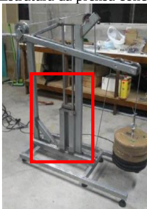
Figura 1 – Estrutura da prensa concluída
