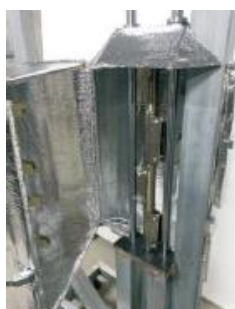
Figura 2 – Estrutura da prensa com sistema de lâmpadas acoplado (a) Câmara de aquecimento instalada (b) Sistema de aquecimento funcionando
