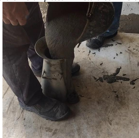
Figura 6 – Slump test – Mistura com fibras
