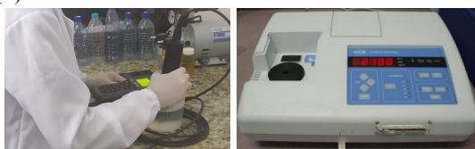
Figura 7- Equipamentos utilizados nas análises físico-químicas (a) multiparâmetro Hanna HI9829 e (b) turbidímetro de bancada Hach 2100N.
