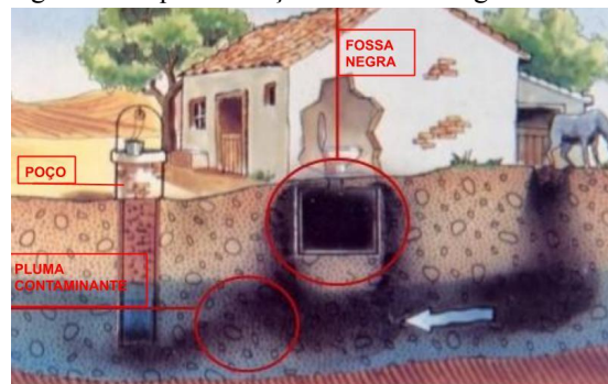
Figura 2- Esquematização das fossas negras.
