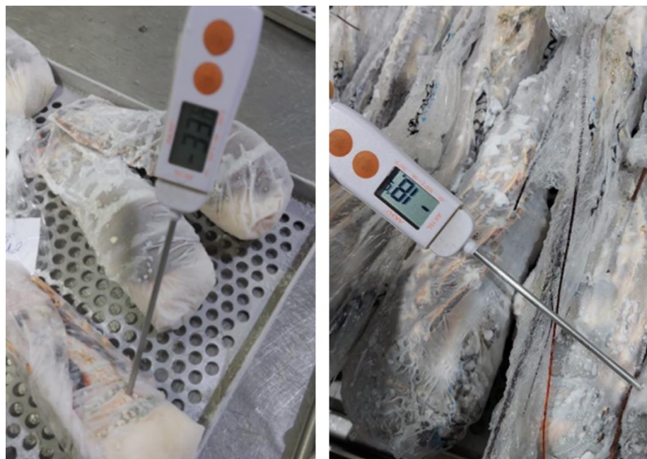
Figura 8. Temperatura de produto saindo de armário de nitrogênio
