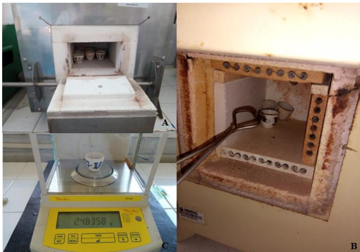
Figura 4. A – cadinhos cheios na mufla antes da queima; B – cadinhos cheios após a queima e C – pesagem da amostra pós queima.
