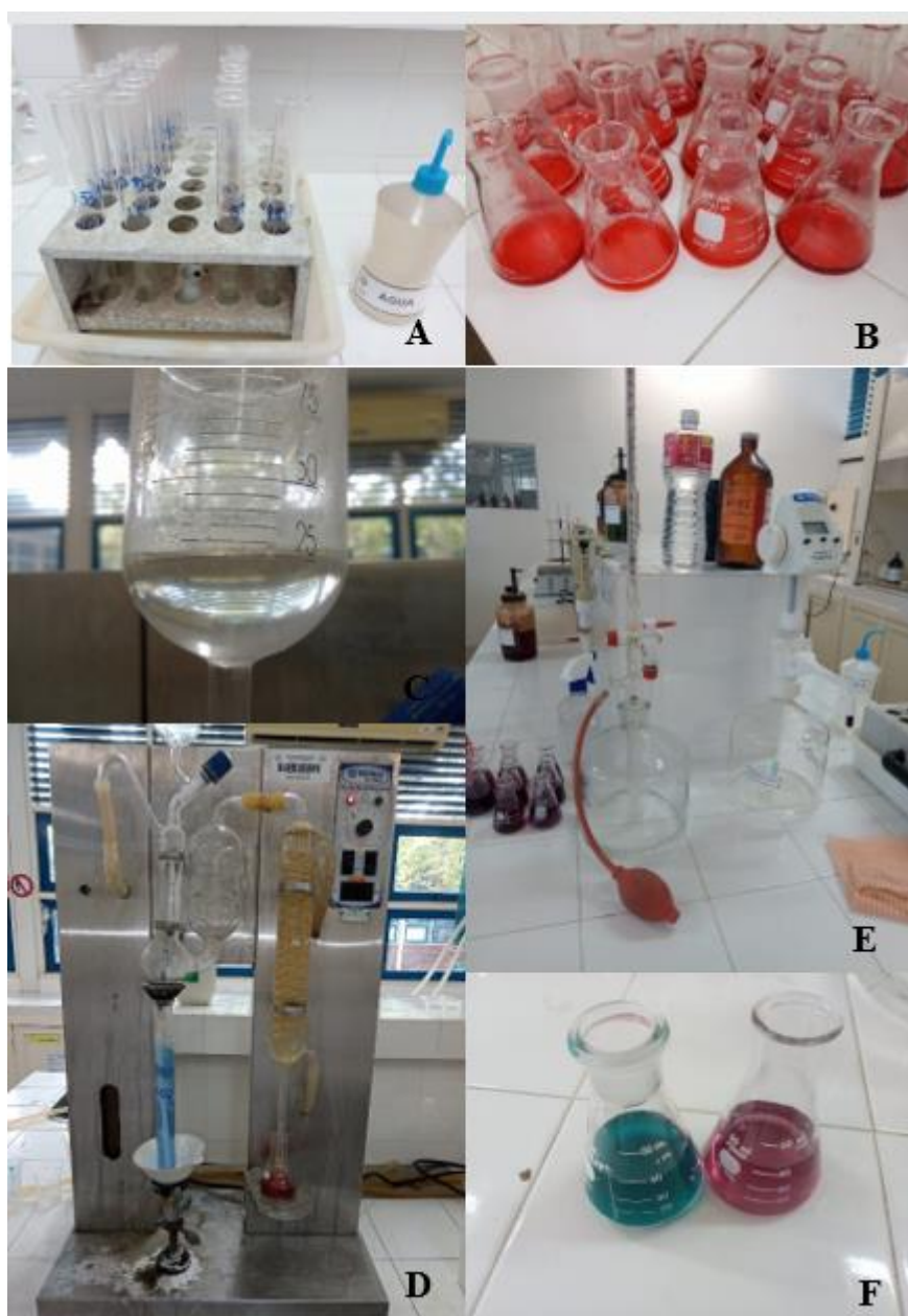
Figura 6. A – adição da água deionizada; B – solução indicadora no Erlenmeyer; C – 25 mL de NaOH; D – destilação; E – titulação e F – destilado antes (azul) e depois (rosa) de titular.
