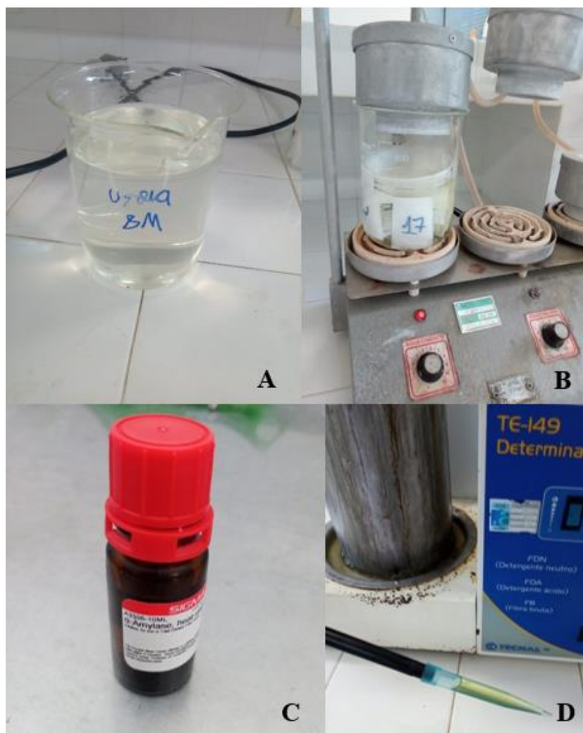
Figura 8. A – ureia 8M; B – aquecendo os sacos submergidos em solução de ureia 8M; C – \alpha -amilase estável ao calor e D – 1 mL de \alpha -amilase.
