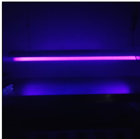
Figura 10. Luz negra para aferição da presença de parasitas na carne dos pescados. Fonte: Autor-2020.
