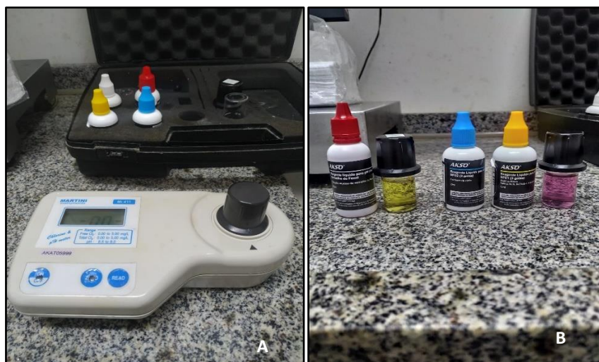
Figura 18. A – Clorímetro para realização da análise de teor de cloro e pH da água; B – Reagentes utilizados nas análises de teor de cloro e pH da água. Fonte: Autor-2020.
