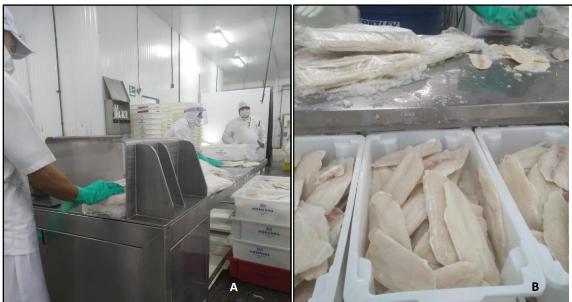
Figura 11. A – Máquina utilizada para desbloqueamento dos pescados; B – Processo de desbloqueamento e separação dos filés sem a presença de plástico. Fonte: Autor-2020.
